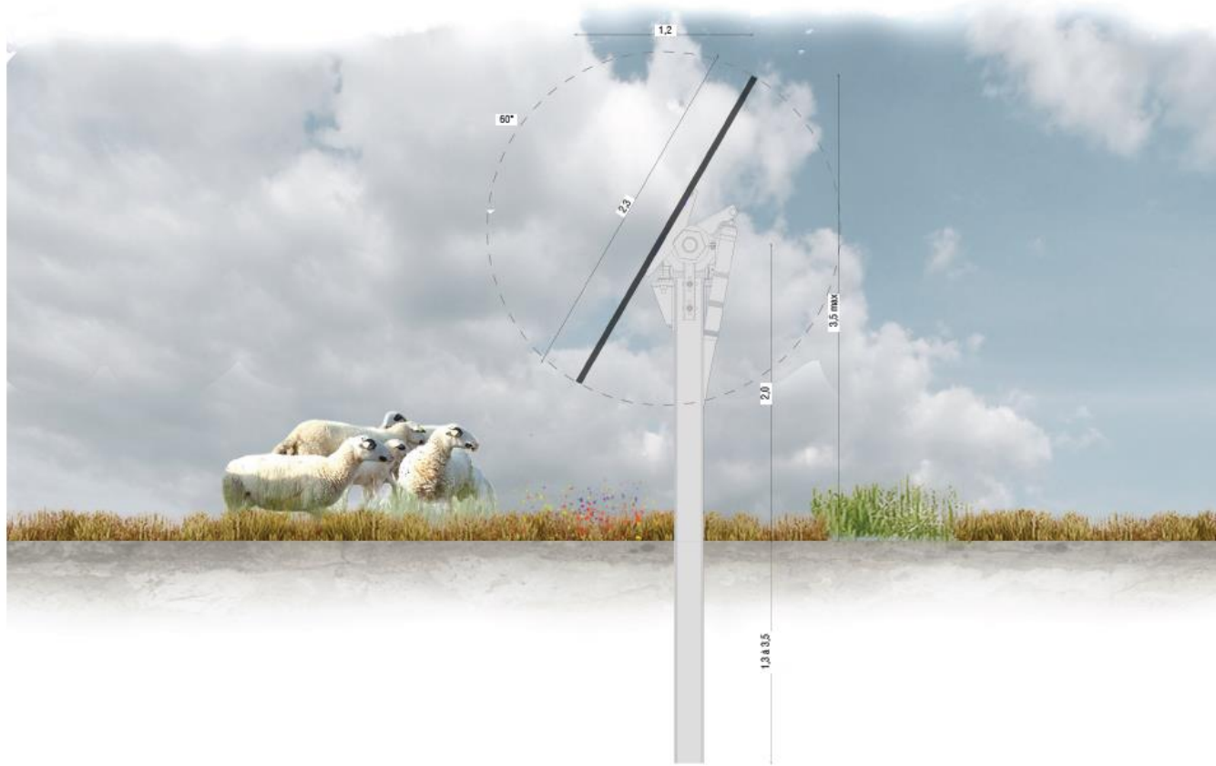
Figure 55 : Vue en coupe d'une table photovoltaïque avec pieux battus (Source - I'M IN ARCHI)
